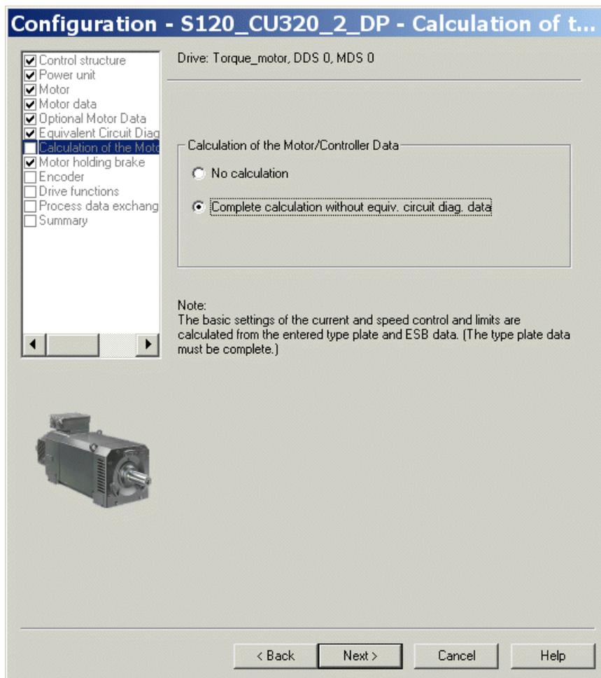
Изображение 2-47 Окно расчета данных двигателя/регулятора
