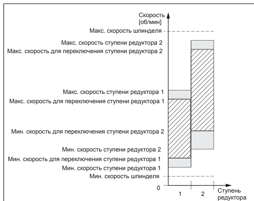
Рис. 9-20 Пример диапазонов скоростей при автоматическом выборе ступеней редуктора (M40)
