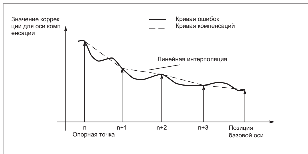
Изображение 5-4 Линейная интерполяция между опорными точками
