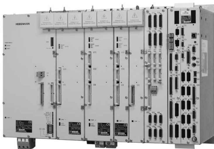
Основной компьютер и блок управления цифровыми приводами с модульной системой преобразователя
