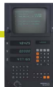
1981: TNC 145, первая система ЧПУ фирмы HEIDENHAIN
