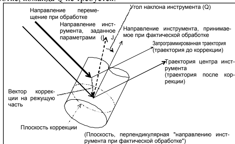
Рис. 22.8.1.1 (b) Угол наклона инструмента при программе 2-го типа
