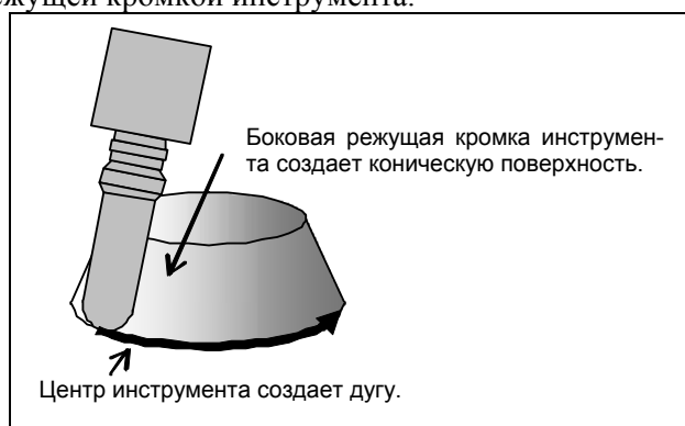
Рис. 22.4 (b) Управление позицией инструмента (круговая интерполяция)
