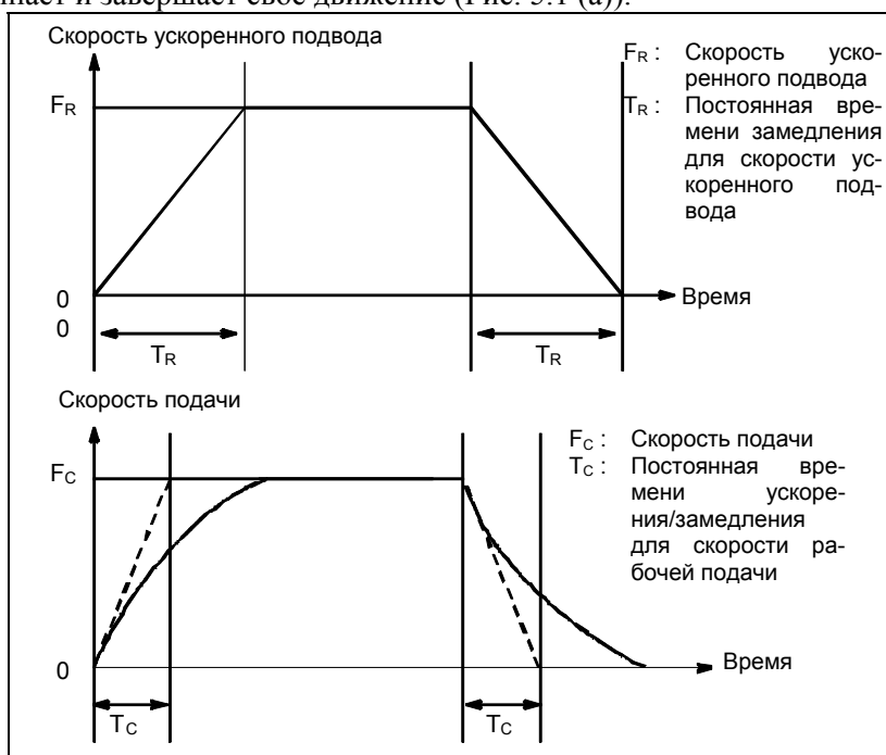
Рис. 5.1 (а) Автоматическое ускорение/замедление (пример)
