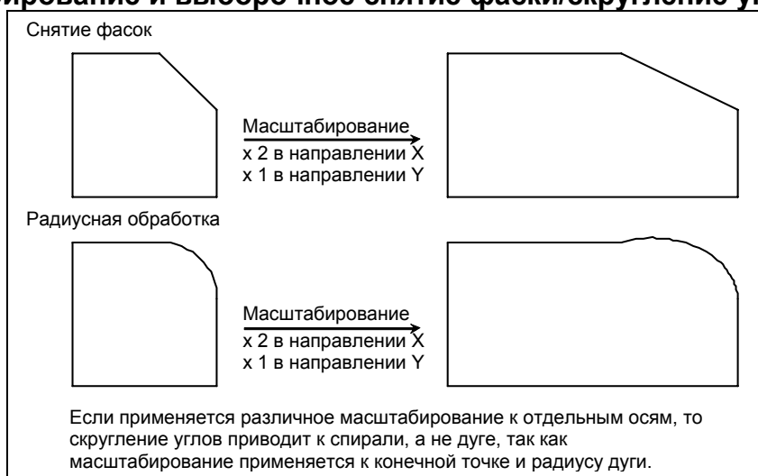
Рис. 15.2 (e) Масштабирование и выборочное снятие фаски/скругление углов
