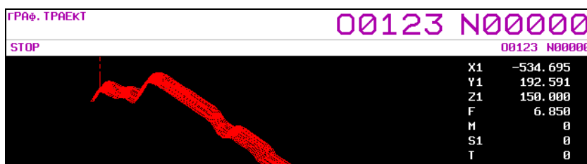
Рис. 13.2.1.2 (к) Индикация состояния во время временной остановки
