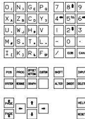
Fig. 1.1 (d) MDI Keyboard of 9.5" LCD/MDI Panel (Horizontal)
